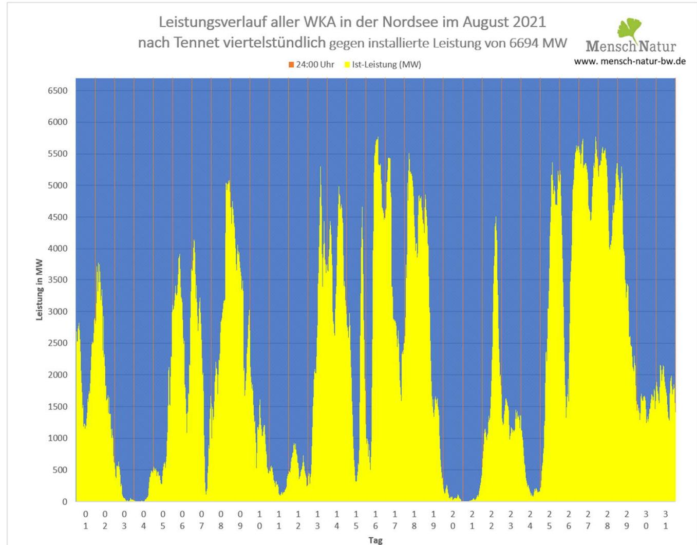
Vergleich Leistungsverlauf Windleistung gegen installierte
