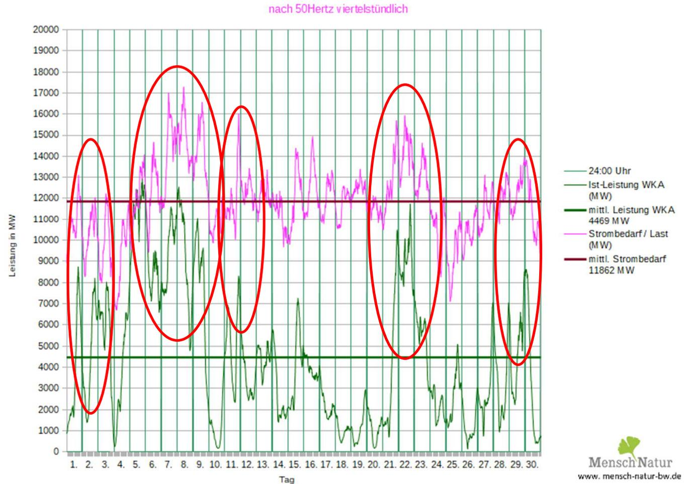
Leistungsverlauf Windleistung gegen Strombedarf (Last)
