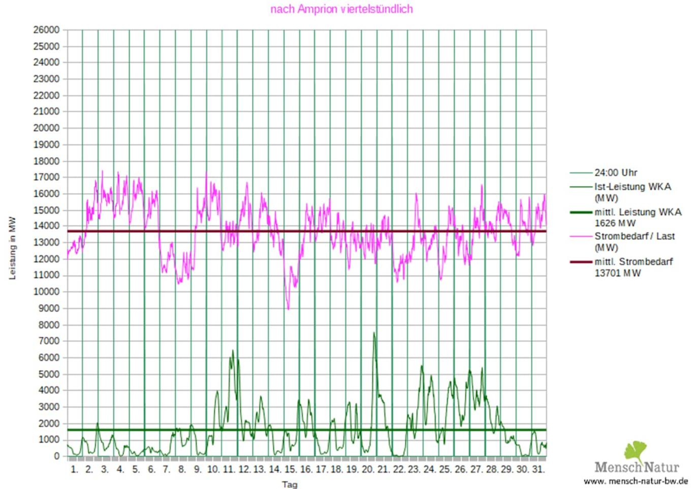
Leistungsverlauf Windleistung gegen Strombedarf (Last)
