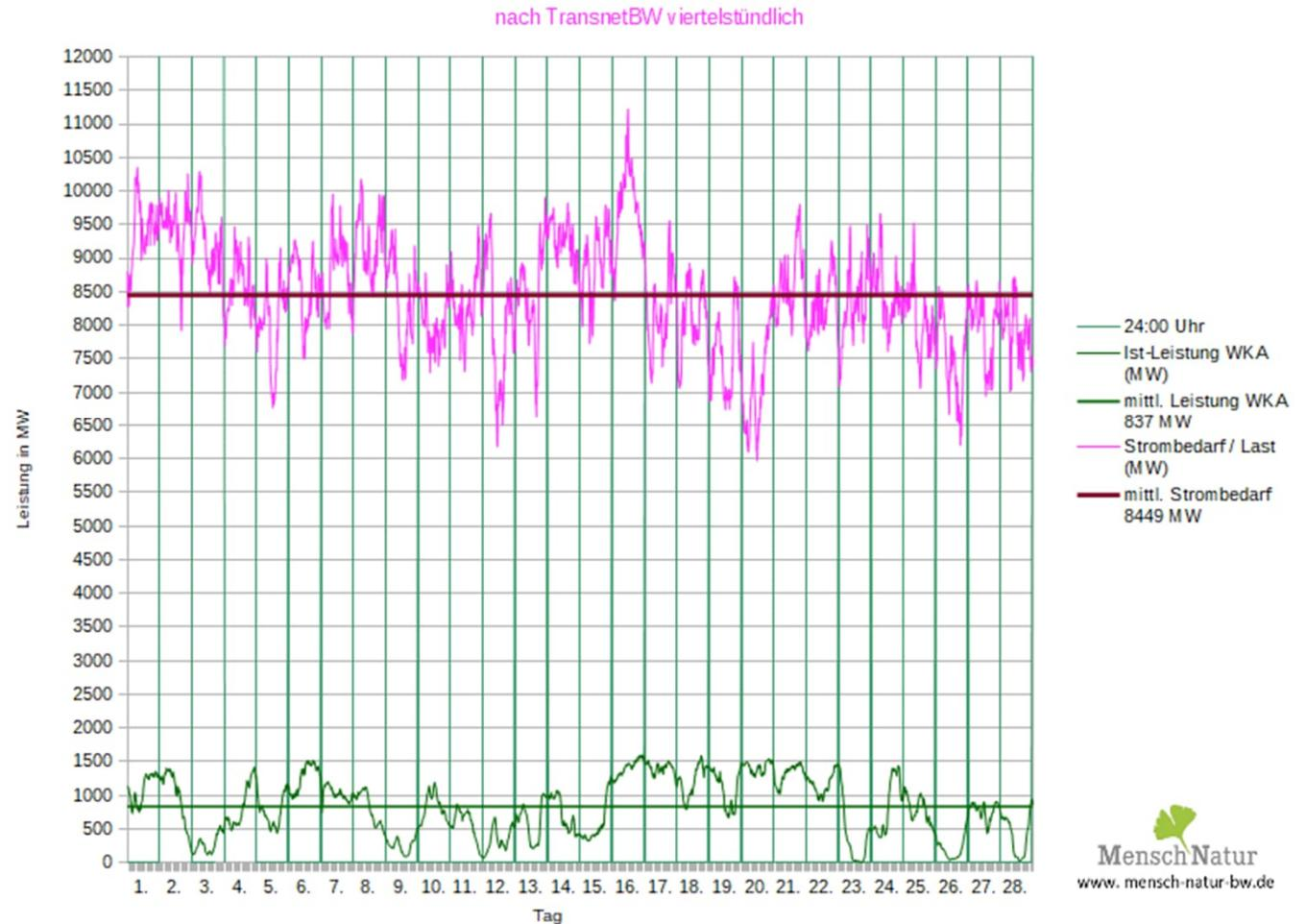
Leistungsverlauf Windleistung gegen Strombedarf (Last)
