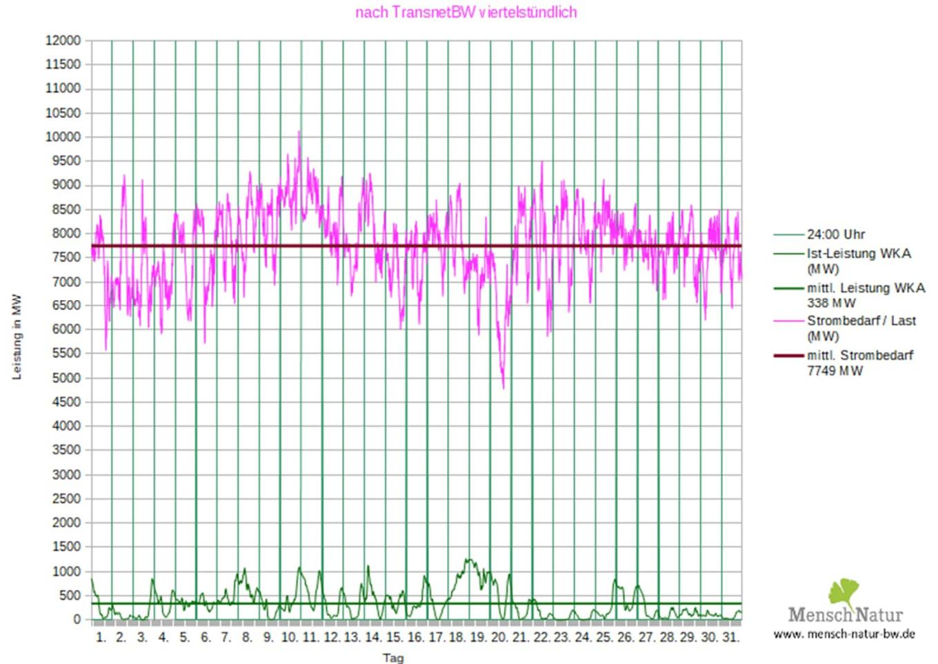
Leistungsverlauf Windleistung gegen Strombedarf (Last)
