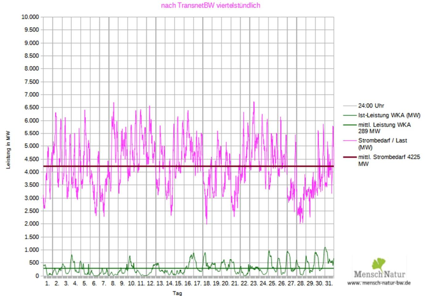
Leistungsverlauf Windleistung gegen Strombedarf (Last)
