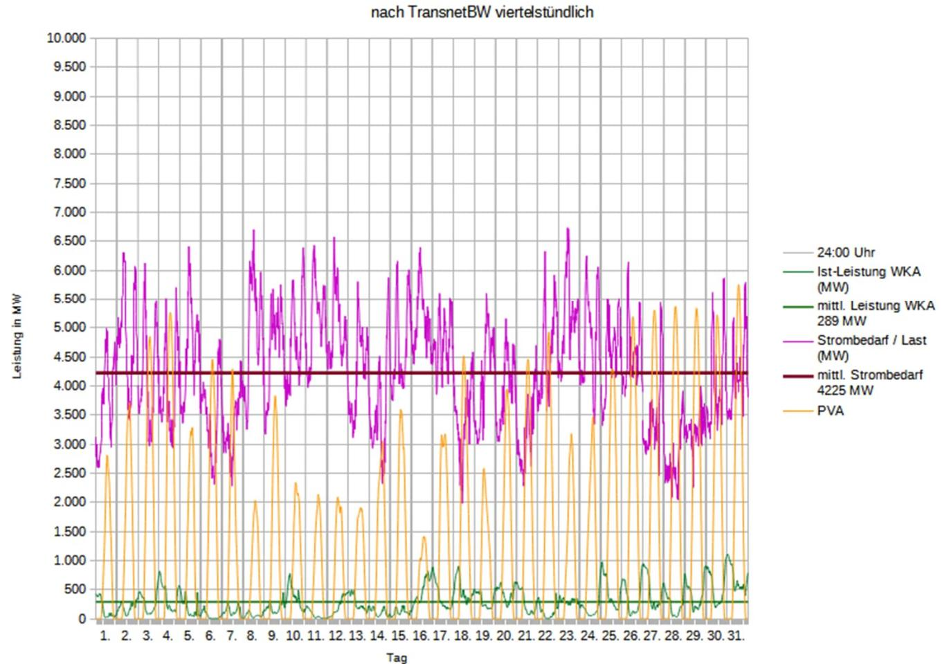
Leistungsverlauf Windleistung gegen Strombedarf (Last)
