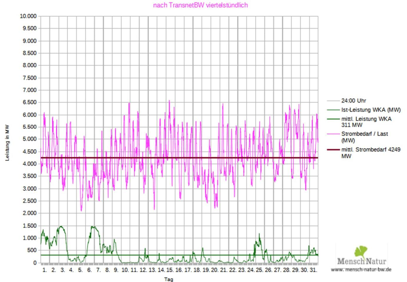
Leistungsverlauf Windleistung gegen Strombedarf (Last)
