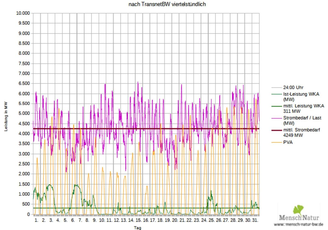
Leistungsverlauf Windleistung gegen Strombedarf (Last)
