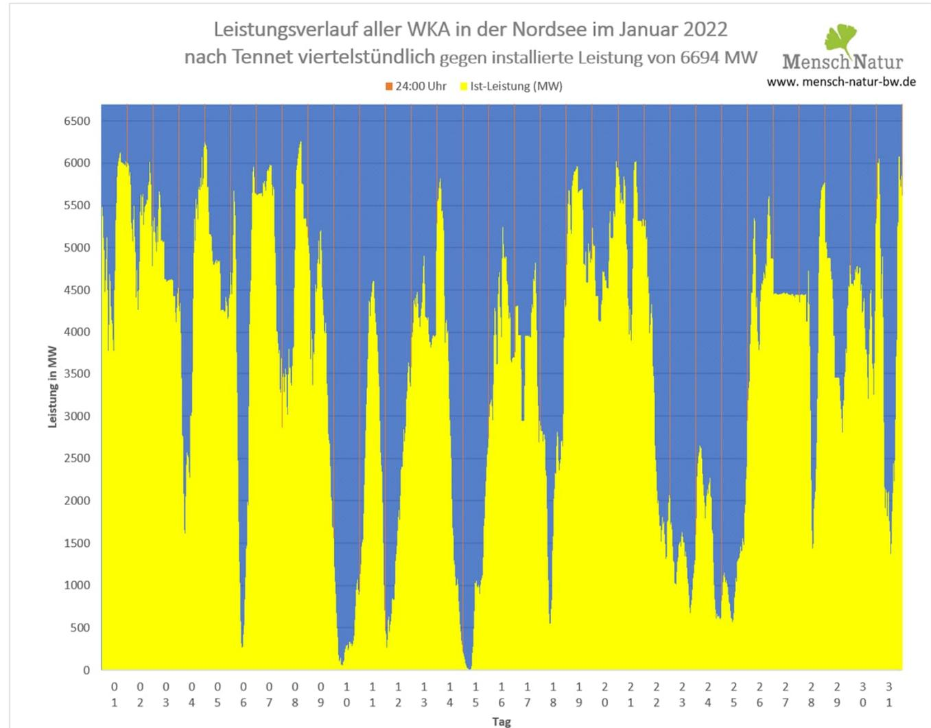
Vergleich Leistungsverlauf Windleistung gegen installierte
