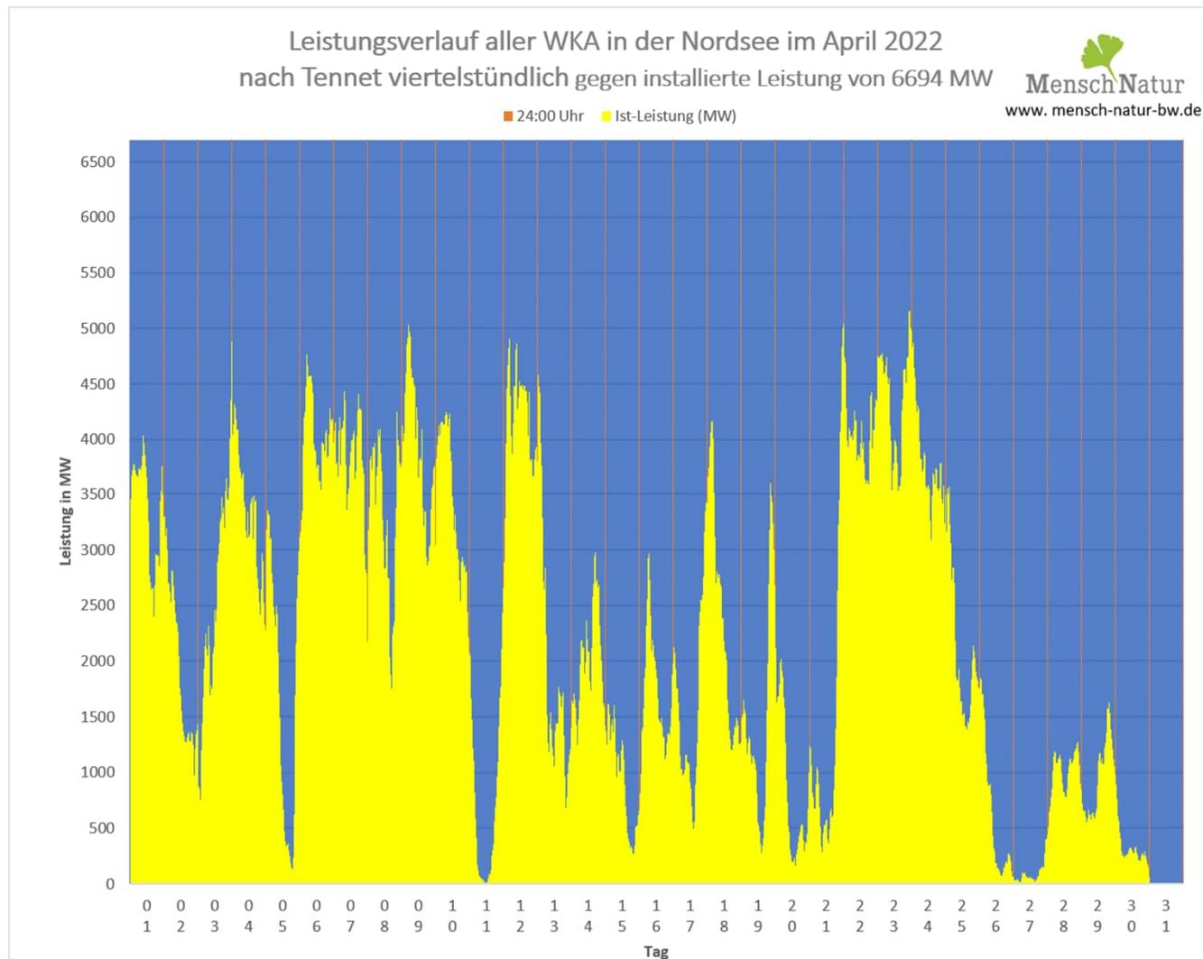
Vergleich Leistungsverlauf Windleistung gegen installierte
