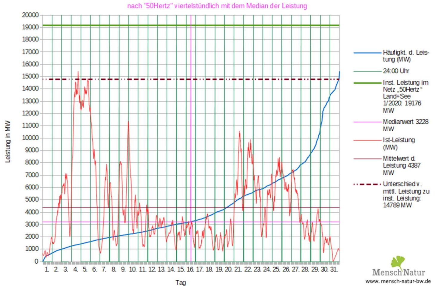
Analyse der Leistungsverteilung von Windenergie an Land und auf See zur installierten Leistung 50Hertz
