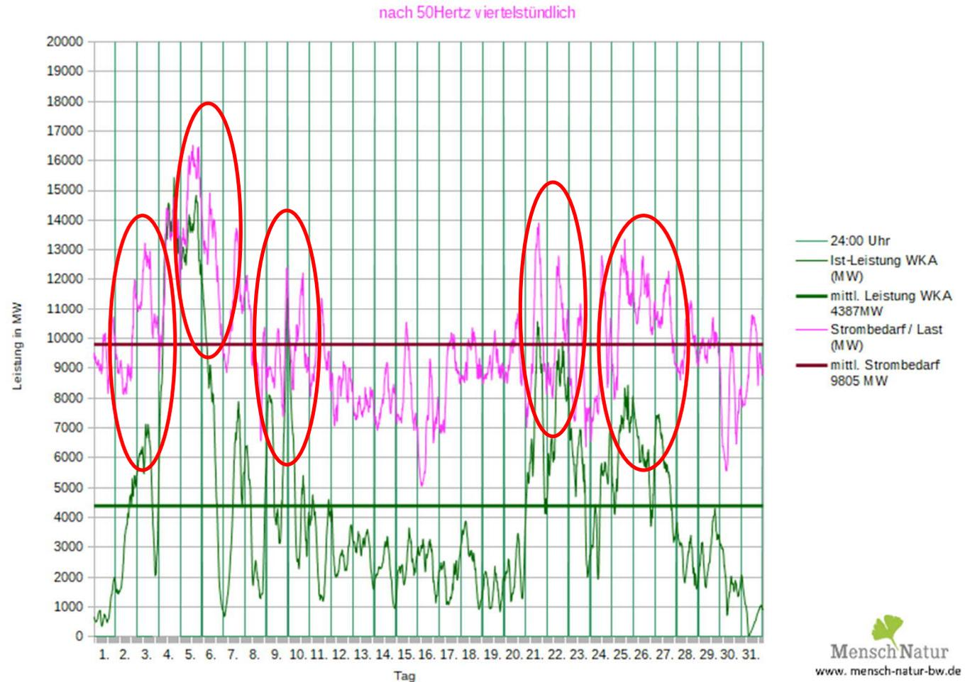
Leistungsverlauf Windleistung gegen Strombedarf (Last)
