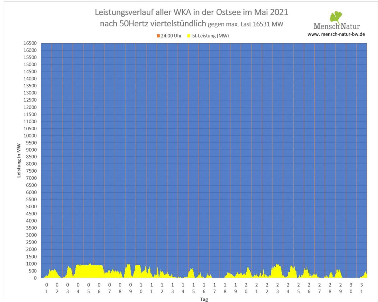
Vergleich Leistungsverlauf Windleistung gegen den maximalen Leistungsbedarf im entsprechenden Monat 50Hertz
