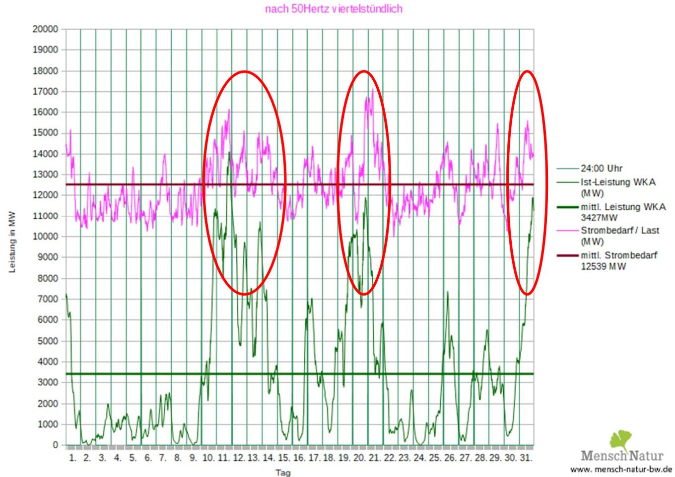
Leistungsverlauf Windleistung gegen Strombedarf (Last)
