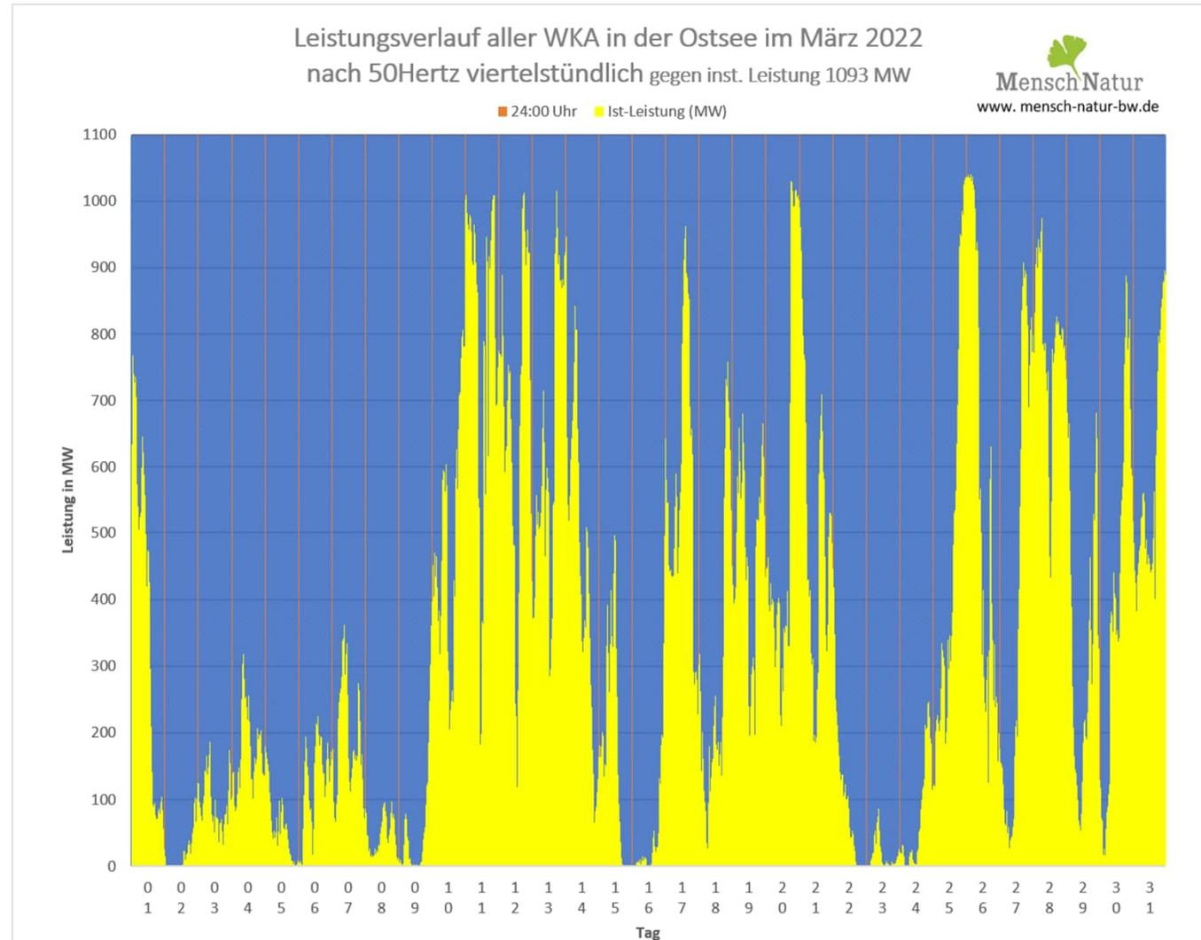
Vergleich Leistungsverlauf Windleistung gegen installierte
