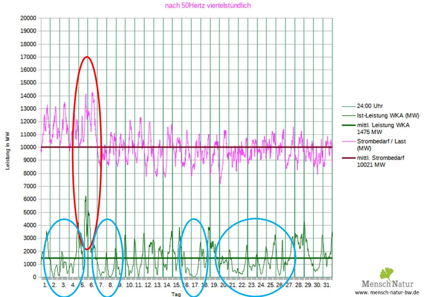
Leistungsverlauf Windleistung gegen Strombedarf (Last)
