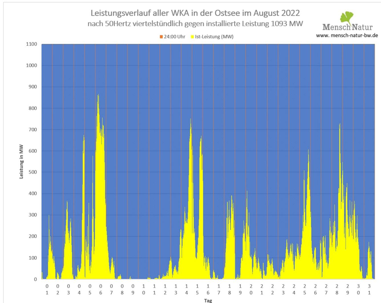
Vergleich Leistungsverlauf Windleistung gegen installierte
