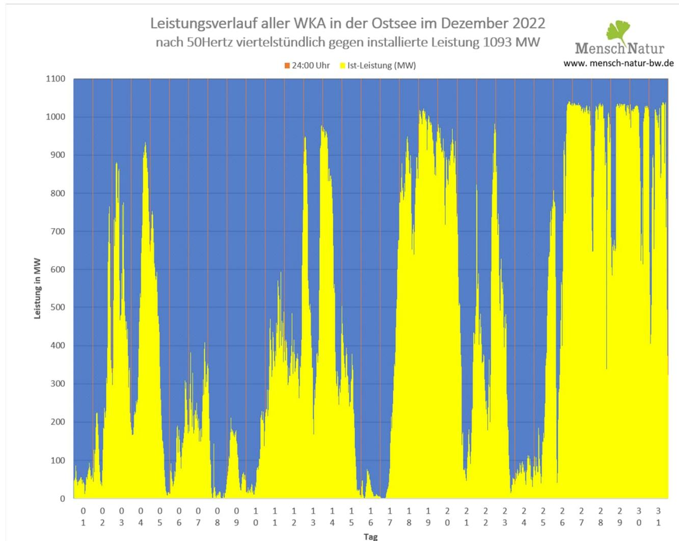
Vergleich Leistungsverlauf Windleistung gegen installierte
