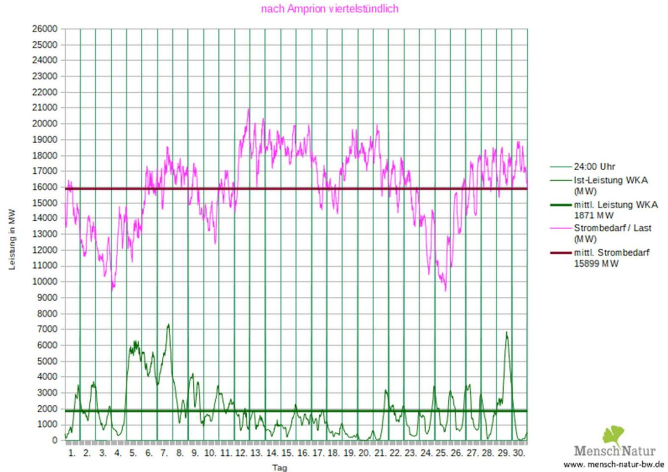
Leistungsverlauf Windleistung gegen Strombedarf (Last)
