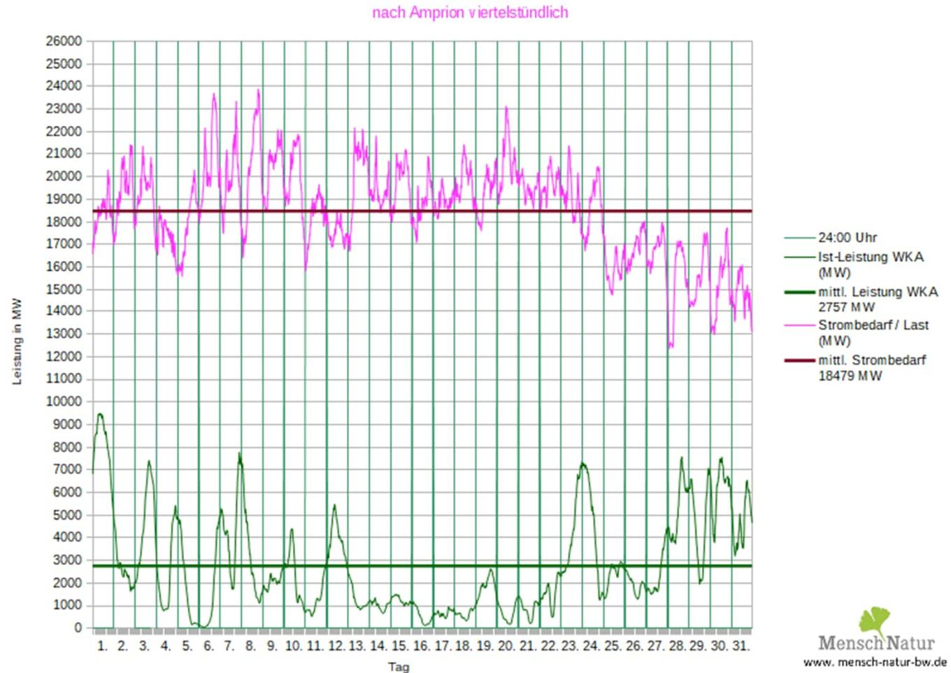
Leistungsverlauf Windleistung gegen Strombedarf (Last)
