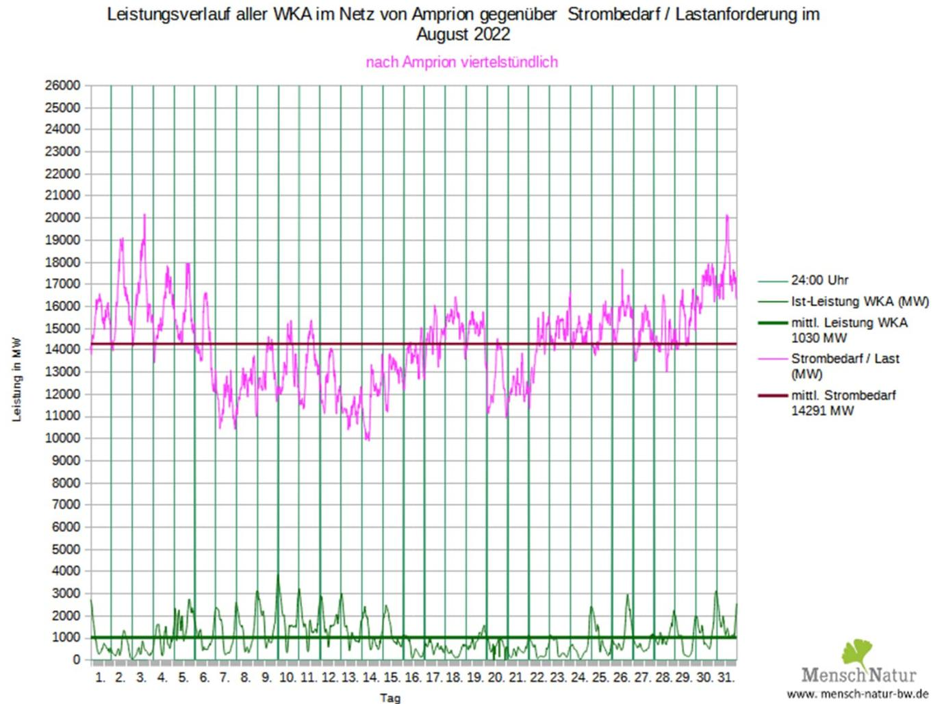
Leistungsverlauf Windleistung gegen Strombedarf (Last)
