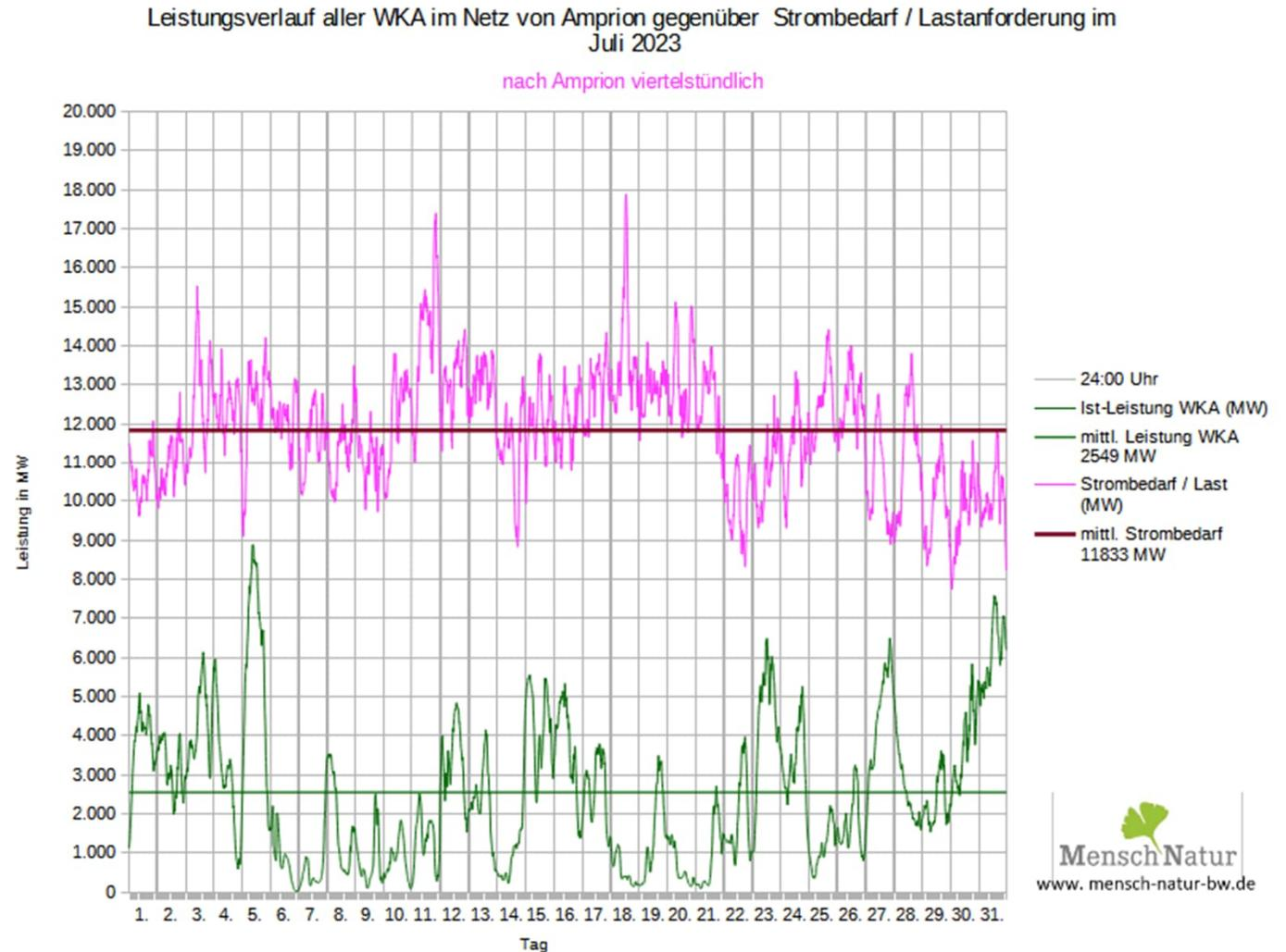
Leistungsverlauf Windleistung gegen Strombedarf (Last)
