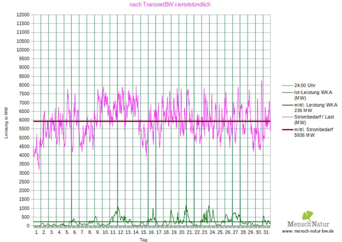
Leistungsverlauf Windleistung gegen Strombedarf (Last)
