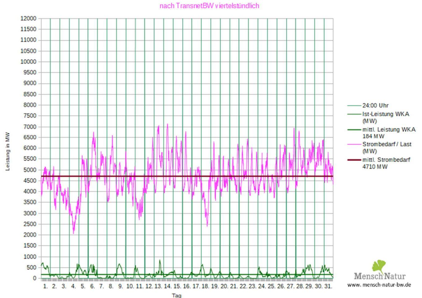
Leistungsverlauf Windleistung gegen Strombedarf (Last)
