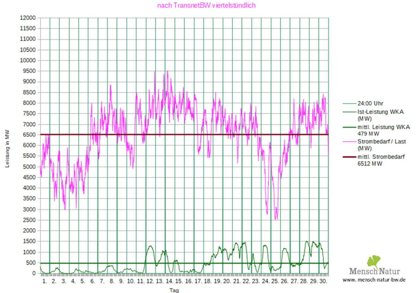
Leistungsverlauf Windleistung gegen Strombedarf (Last)
