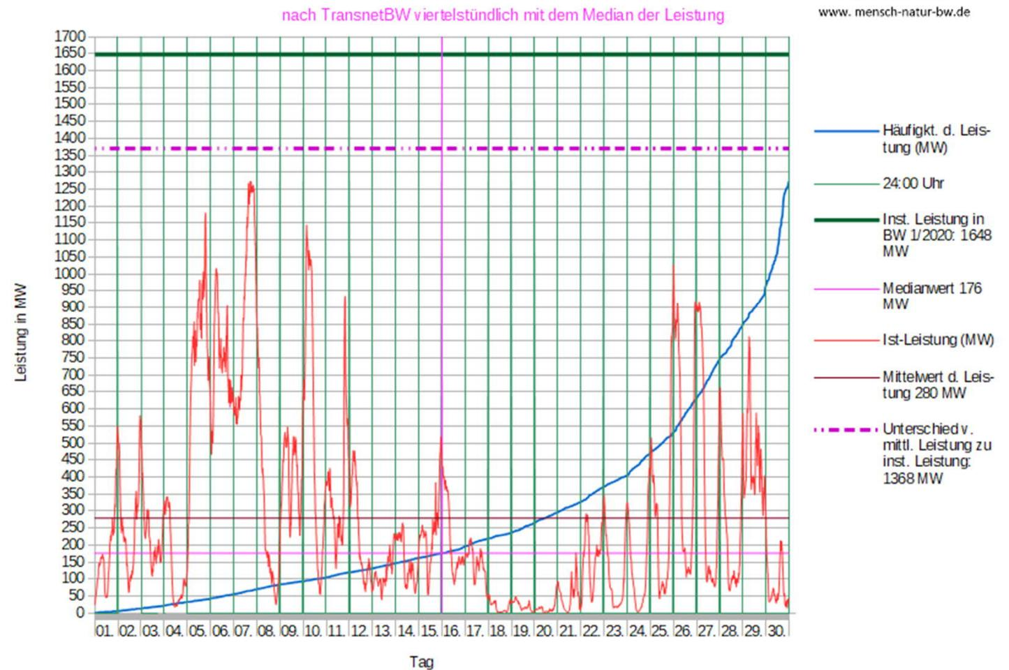
Analyse der Leistungsverteilung von Windenergie zur installierten Leistung TransnetBW
